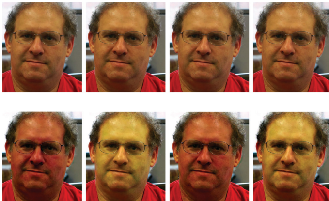
Рис. 1. Обработка видео с помощью эйлерова увеличения. В верхнем ряду — кадры оригинального видео, во втором ряду — после обработки
